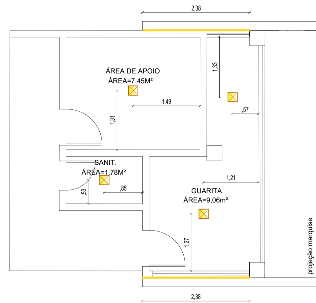
PLANTA DE ILUMINAÇÃO ESCALA 1/50
